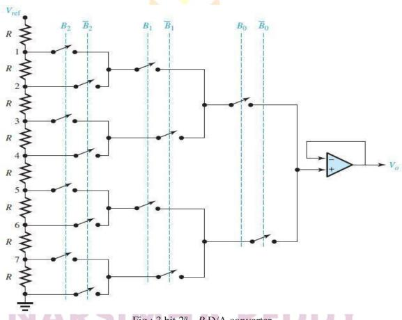
Fig.: 3 bit  $2^n - R$  D/A converter
