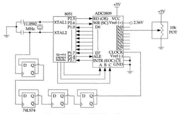
Fig.: Interfacing of ADC 0808
